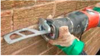
Bild 4.8a. Tigersåg med blad anpassat för borttagning av fog. (Thorpe Industries Ltd, Cutlas saw blade)
