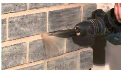
Bild 4.6a. Borrhammare eller bilningshammare med olika mejslar.
