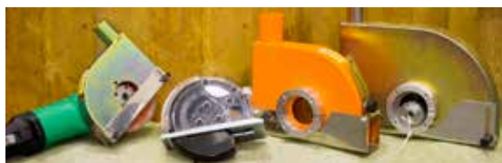
Bild 4.4a. Vinkelslip kombinerad med anordning för anslutning till dammsugare. (Sunrise Tools & Equipment, C-Tec)
