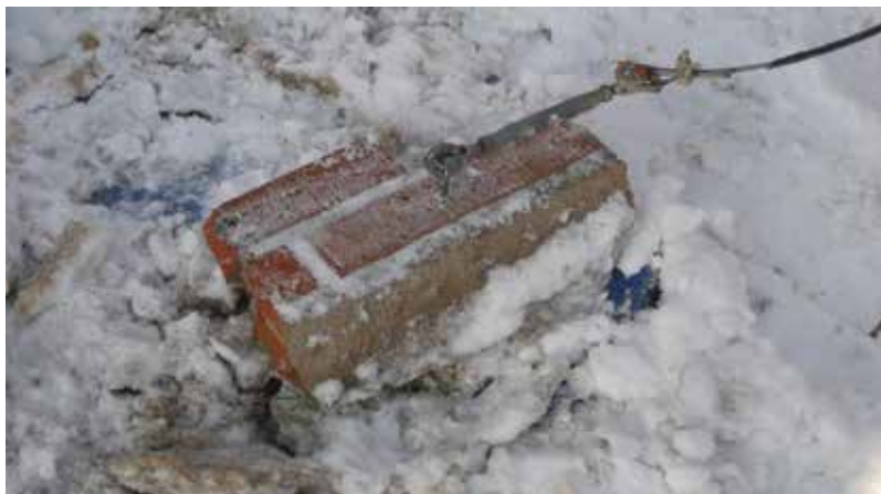
Bild 5.2. Vajer som varit infäst i skalmuren.
